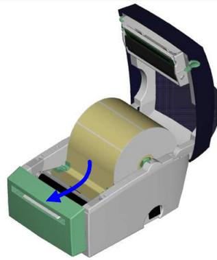
11. Führen Sie den Etikettenrollenansatz durch den Abscheider und drücken Sie die FEED Taste, um den Vorgang zu beenden.
