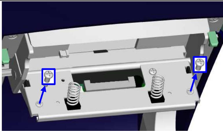
6. Entfernen Sie den Druckkopf, indem Sie ihn am vorderen Ende auf der unteren Seite der Druckkopfhalterung entnehmen und setzen den neuen Druckkopf ein.
