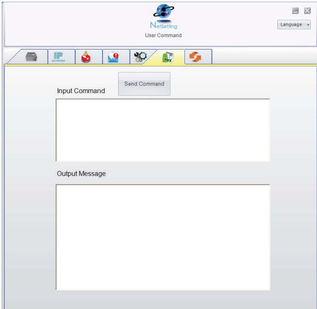
Mit der Schaltfläche **Send Command** können Sie Druckerbefehle über den Ethernet-Port senden, um den Drucker aus der Ferne zu bedienen.
