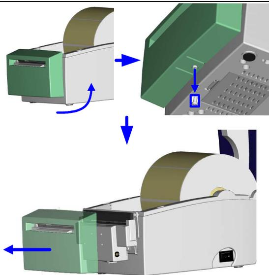
3. Die Abschneidereinstellschraube befindet sich auf der Seite des Abschneiders. Drehen Sie mithilfe eines Schraubenziehers die Schraube gegen den Uhrzeigersinn, um das Papiermesser zu lösen und das gestaute Etikett zu entfernen.
