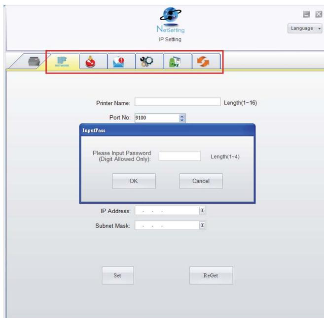
Die Benutzeroberfläche hat im oberen Bereich sechs Registerkarten, mit denen Sie verschiedene Netzwerkeinstellungen konfigurieren können. Zur Gewährleistung der Datensicherheit benötigen Sie jedoch ein Kennwort, um diese Konfigurationsseiten zu öffnen.
